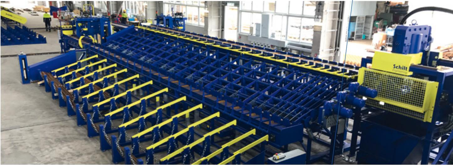
^ Sammelboxen zur Aufnahme der Stangen nach dem Schnittvorgang
