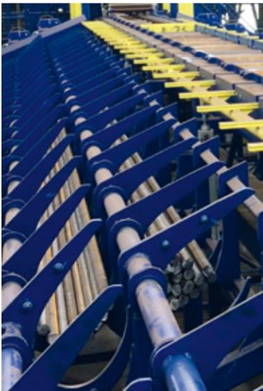
Öffnen und schließen, um Stäbe in zufälliger Reihenfolge zu lagern
